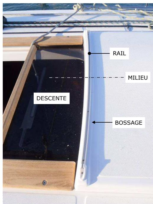
CENTRER LE RAIL SUR LA LARGEUR ET LA PROFONDEUR DU BOSSAGE
